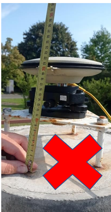
pro určení výšky antény u bodů s nucenou centrací nepoužívat pomocnou nivelační značku
