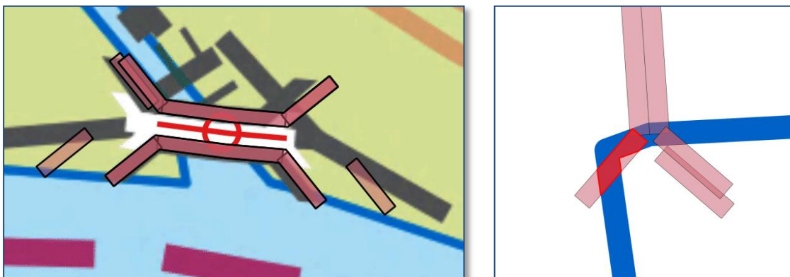
Obrázek č.5 Nesprávné rozmístění "křidélek" značky mostu
