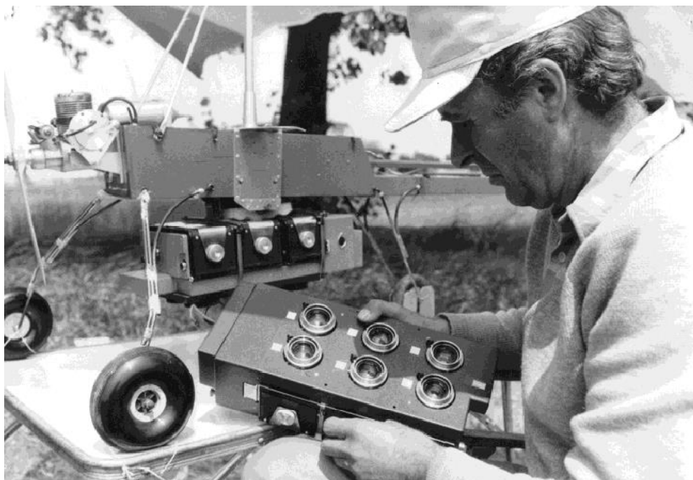
Obrázek 2 Multispektrální kamera Flexaret M-6 umístěná na modelu „Rogallo 1981“ v rukou J.Trnky (archív RNDr.Ladislava Plánky,CSc.).
