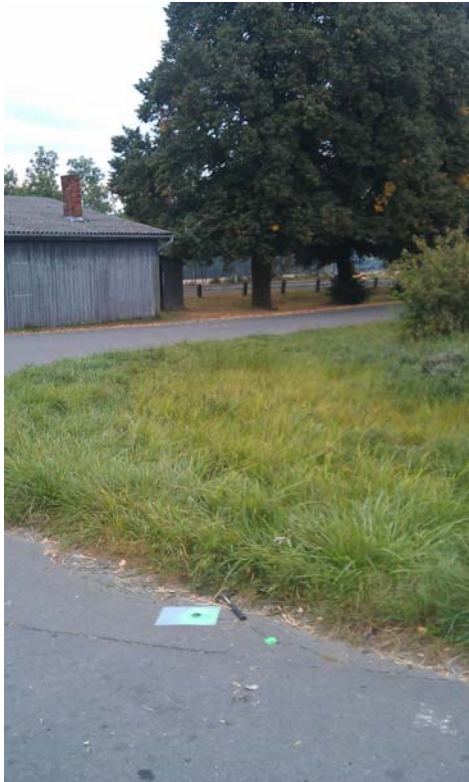
Obrázek 22 stabilizace trvalá hřebem signalizace nástřikem přes šablonu
