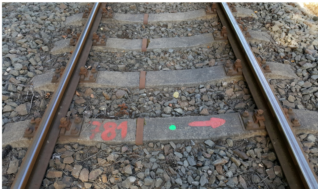
Obrázek 21 VB nástřikem přes šablonu – průměr 5cm pro snímkování s GSD=2cm
